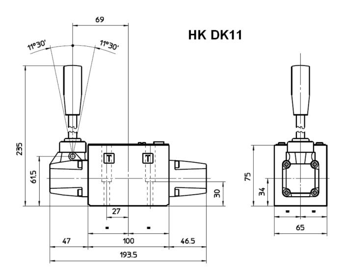
Schraubensatz: 6 Inbusschrauben M6x40 12.9 Screw set: 6 socked head screws M6x40 12.9
