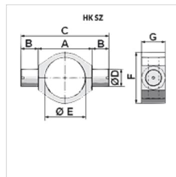
**Nota**Tolerancia  $\varnothing E \leq 100: +0,2$ ; Tolerancia  $\varnothing E > 100: +0,4$
