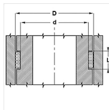
**Nota**Cálculo da força transversal;  $F = p \times D \times L \times n$  $F$ = máxima força transversal (N) $p$ = máxima compressão de superfície (N/mm<sup>2</sup>) $D \times L$ = superfície projetada (mm<sup>2</sup>)
