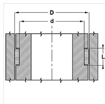
**Указание**Расчет поперечного усилия;  $F = p \times D \times L \times n$  $F$ = максимальное поперечное усилие (N) $p$ = максимальное напряжение поверхности (Н/мм<sup>2</sup>) $D \times L$ = проецируемая поверхность (мм<sup>2</sup>)
